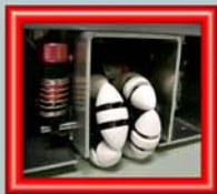
Roue bi-directionnelle avant, sur amortisseurs
